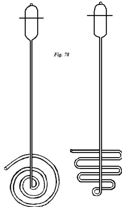
Ad commodiorem hujus Barometri impletionem non abs re fore notat Autor, si ramus perpendicularis AB in exiguum tubulum in L apertum desinat, ita ut per ejus orificium argentum vivum infundi possit, dum orificium rami horizontalis C, obstructum tenetur.
