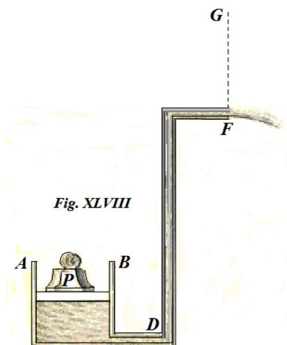
§. 9. Cum aquae expelluntur per canalem  $D F$  (Fig. 48) habentque in orificio  $F$  velocitatem quae debeat altitudini verticali  $GF$ , est *potentia absoluta* eadem tempore impensa proportionalis velocitati aquae in  $F$  ductae in altitudinem  $G$  supra  $AB$ .
