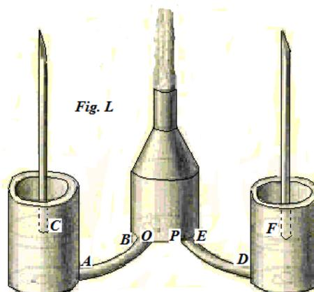
quantitates sunt ut  $mn$  ad  $mn + \alpha\alpha$ . Considerabile certe est hoc dispendium, si iconibus harum machinarum fidere licet, in quibus saepe orificia  $o$  &  $p$  minora sunt orificio effluxus  $H$ , quod si foret plus quam dimidium perderetur *potentiae absolutae*. Erunt autem canales  $AB$  &  $DE$  per totum tractum, quantum id licet, amplificandi, ut machina parum de sua praestantia perdat.
