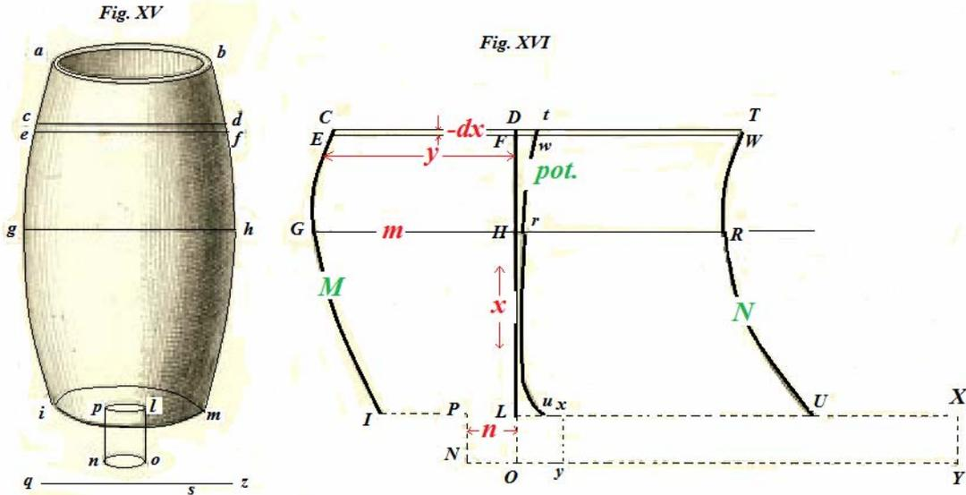
Sit igitur ut in §. 6 Sect. III vas propositum *aimb* (Fig. 15 & 16), quod affusione aquarum constanter plenum servatur usque in *cd*; effluent autem aquae per foramen *pl*; ponaturque eam aquae quantitatem jam effluxisse, quae contineri possit in cylindro super foramine *pl* erecto altitudinis *x*, ultimam autem guttulam effluxisse velocitate, qua ascendere possit ad altitudinem *qs* seu *v*; sic jam exhibenda erit aequatio inter *x* & *v*.
